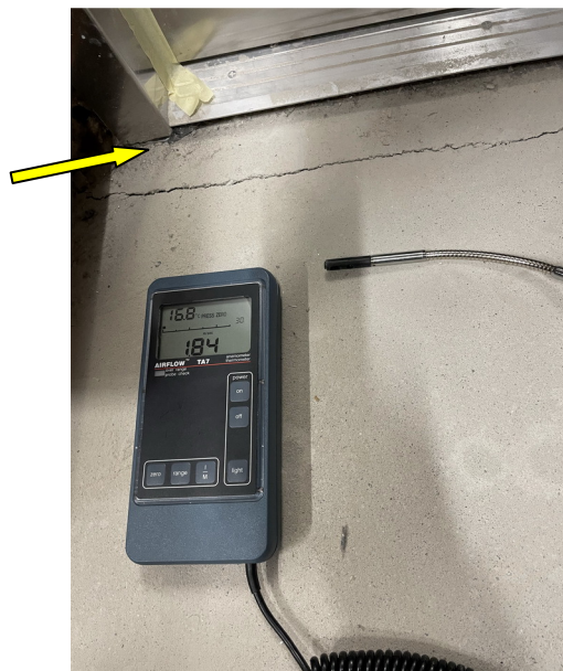
liftajtó - alul, küszöb alatt, nyílástól kb. 15 cm-re
